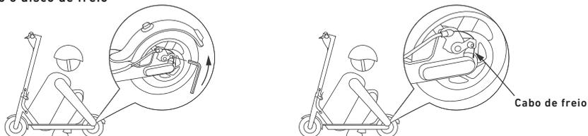
**Freio apertado:** usando a chave tipo allen e gire os parafusos no sentido anti-horário da polia do esticador do disco de freio, encurte ligeiramente o comprimento do cabo do freio e aperte a polia tensora.
